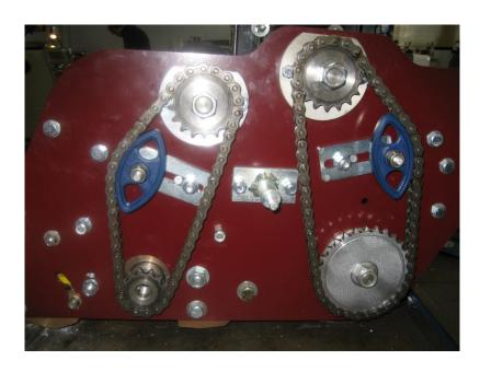
THE CHAINS SHOULD NEVER BE ADJUSTED TIGHTLY.
